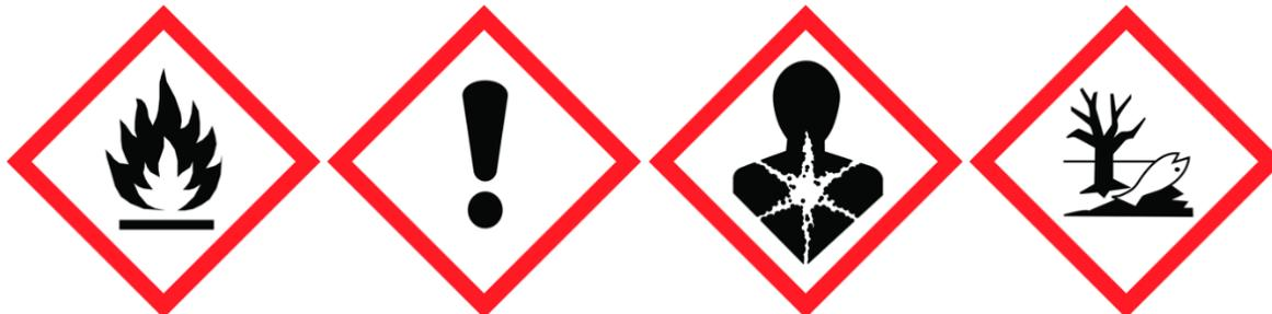
Mantenga el recipiente bien cerrado y alejado del calor/chispas/llamas abiertas/superficies calientes. - No Fumar. Tomar medidas de precaución contra las descargas electrostáticas. Contenedor de tierra/fianza y equipo de recepción. Use equipo eléctrico/de ventilación/iluminación a prueba de explosiones y solo herramientas que no produzcan chispas. Use solo al aire libre o en un área bien ventilada. No respire el polvo/el humo/el gas/la niebla/los
